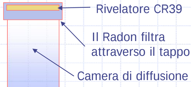
Schema di funzionamento dei rivelatori utilizzati
